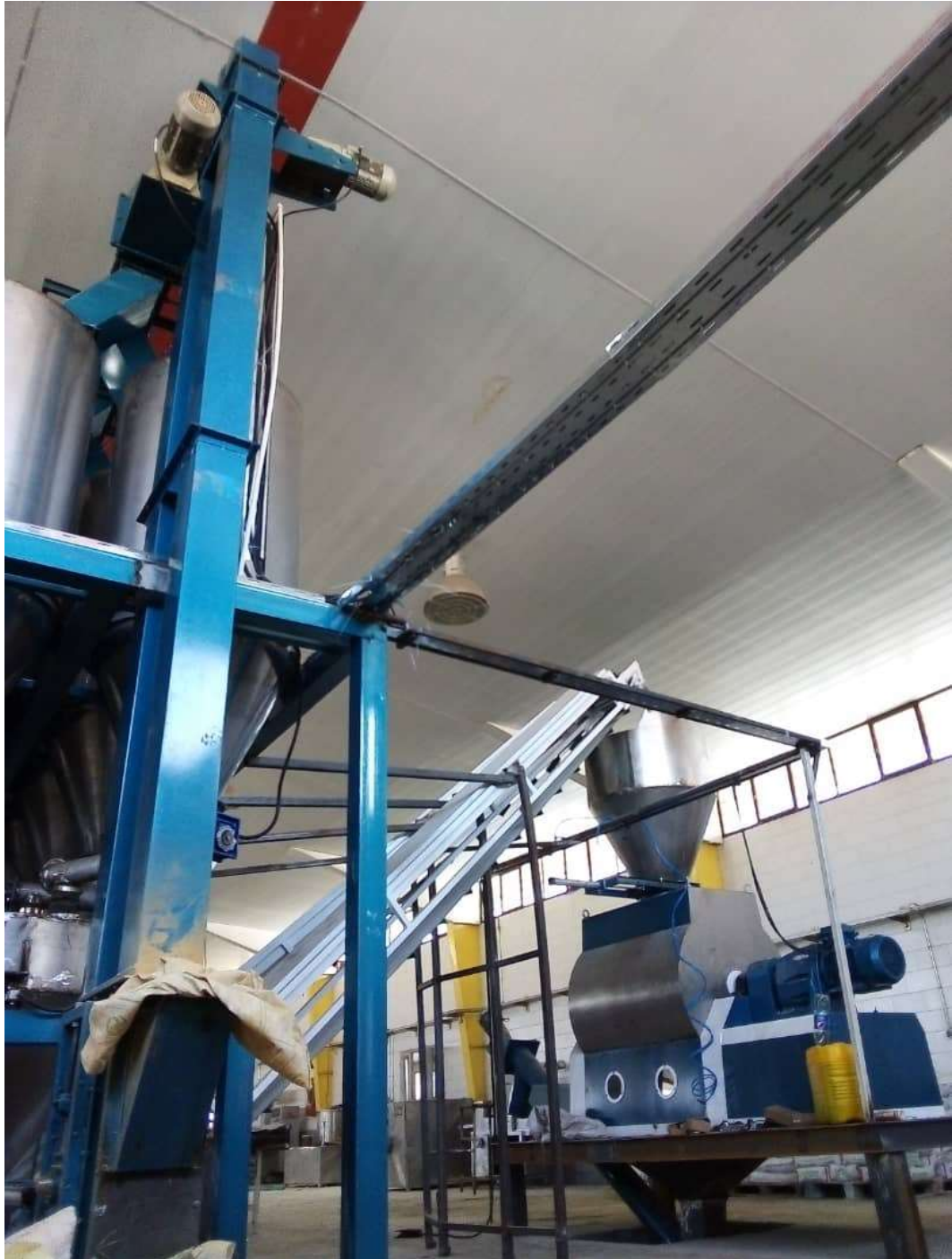
تصویر (۱) هاپر انتقال مواد اولیه به ورودی های بالای مخازن ذخیره سازی مواد اولیه
